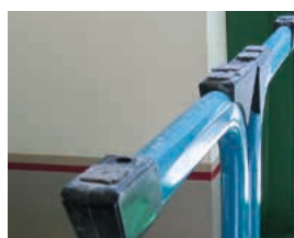
Scharfkantige, beschädigte, abgenutzte und ungeeignete, verschmutzte Stuhlgleiter
