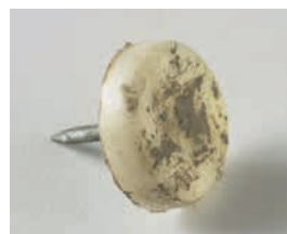
Nylongleiter mit starker Schmutzanhaftung nach achtmonatiger Nutzung
