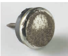
Metallgleiter mit Schmutzanhaftungen nach siebenmonatiger Nutzung
