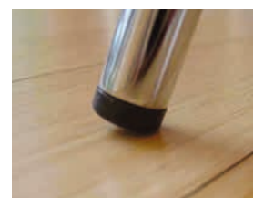
Ungünstige Geometrie führt zu hoher Punktlast
