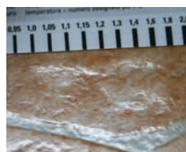
Bleibende Eindrücke durch hohe Punktlast und harte Gleiter
