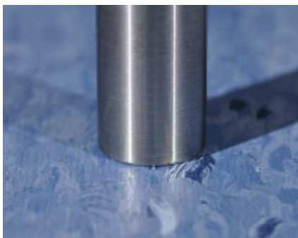
Abb. 1: Normdruckstempel, DIN EN ISO 24343 auf PVC Belag, Druckfläche 100 mm 2 [3]
