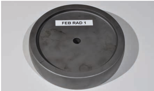
Abb. 3: Testrad aus Stahl (Referenzrad) [2]
