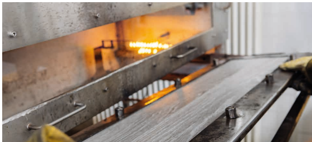
Vorbereiten eines Brandtests für Bodenbeläge, Foto: TFI Aachen
