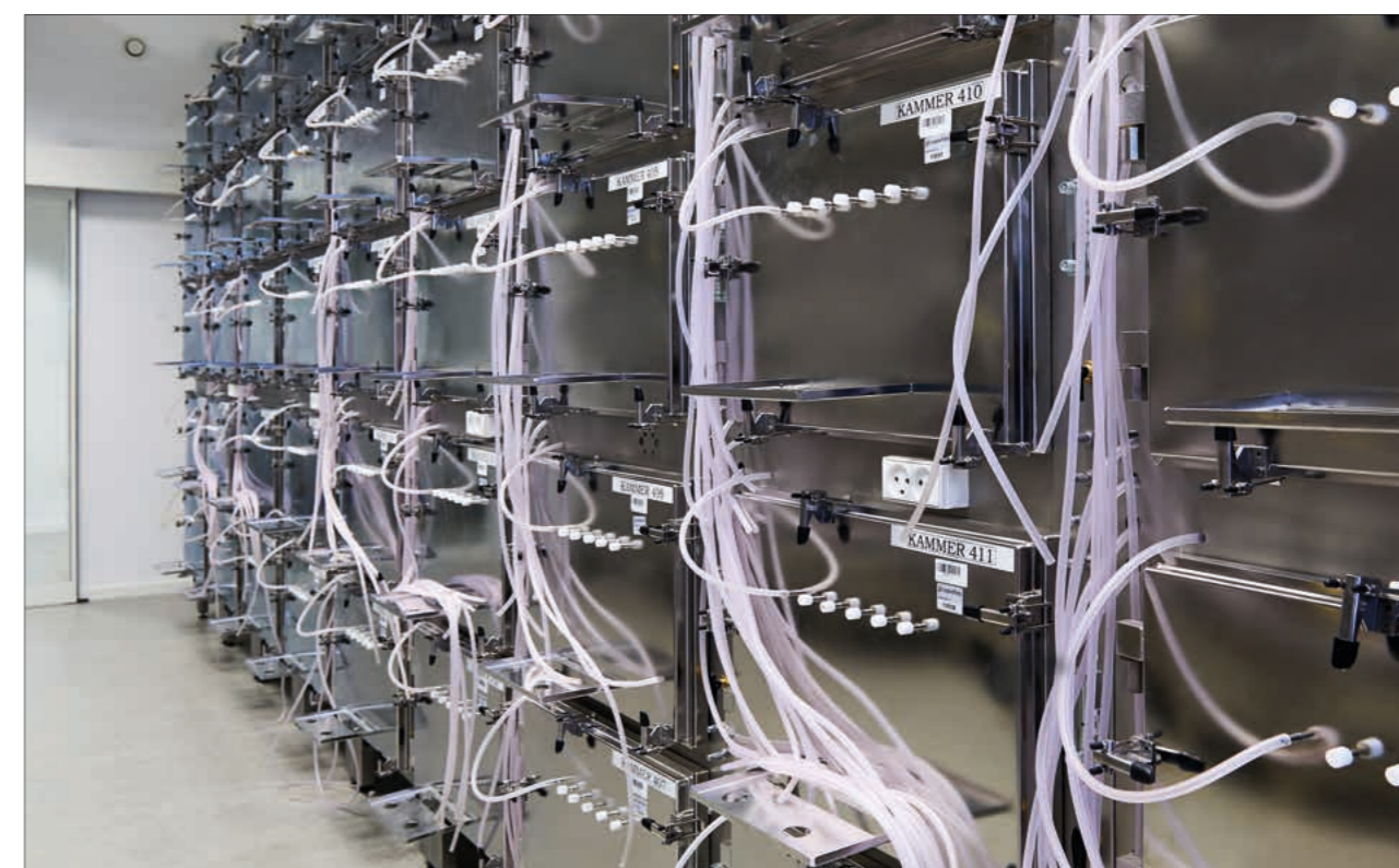
Eine Reihe von Testkammern (Modellräume) zur Prüfung flüchtiger organischer Komponenten, Foto: Eurofins
