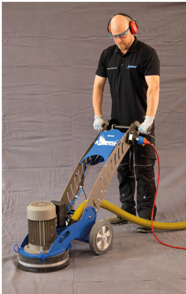
Bodenschleifer mit starker Absaugung sind heutzutage ein Muss.
