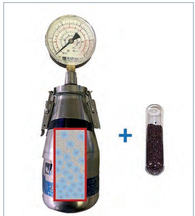
CM-Gerät mit enthaltenen Stahlkugeln und Glasampulle mit Calciumcarbid
